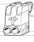
Типичный клапанный блок серии Т, объединяющий различные потоки и функции клапана
