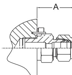
A = 31,50 мм (1,25 дюйма) 6 мм/1/4 дюйма труба
