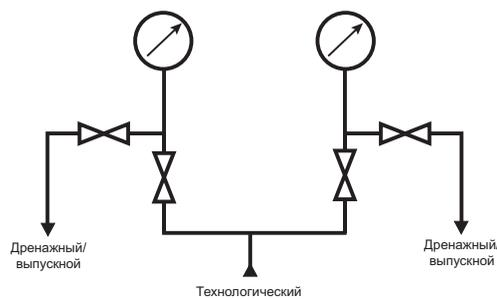
Во всех манифольдах просверлены отверстия, предназначенные для монтажа на крепежных скобах – в комплекте имеются стандартные несущие скобы для манифольдов.
