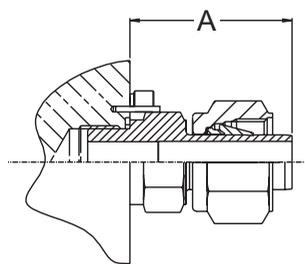
A = 29,70 мм (1,17 дюйма) 6 мм/1/4 дюйма труба
